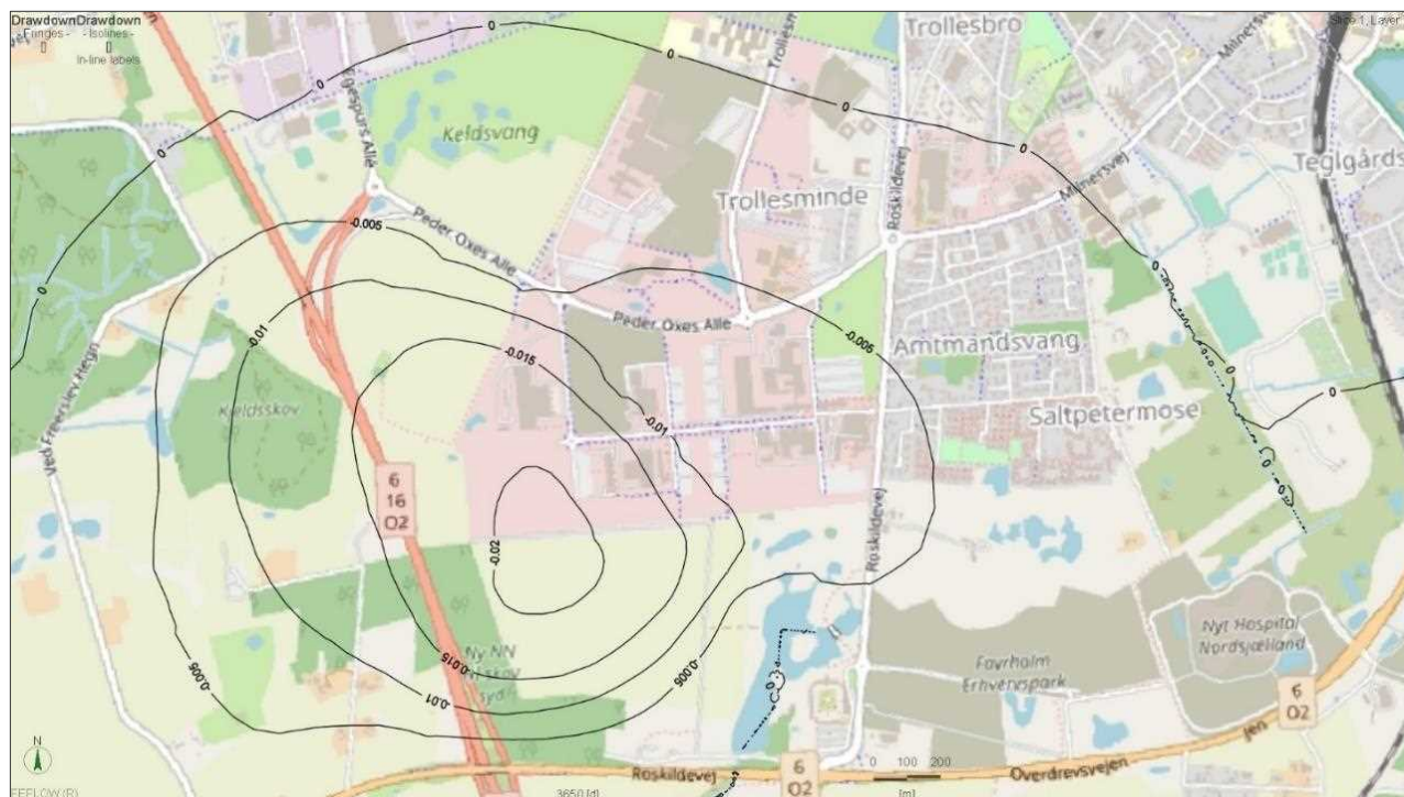
Figur 4-6 Sækning i terrænnært grundvand efter en driftsperiode med 20 års drift af Novo Nordisk ATES-anlægget i kombination med 10 års drift af FOSS ATES-anlægget
