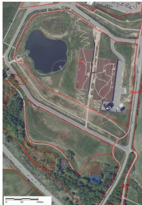
Figur 2. Luftfoto med matrikelgrænser over HCR Syd. Det meste af det rensede spildevand (ca. 95 %) ledes direkte til Pøle Å, mens en mindre del (cirka 5%) pumpes op i lagunen efter rensning, hvorfra det pumpes videre mod udledningspunktet i Pøle Å, tre km nordpå.
