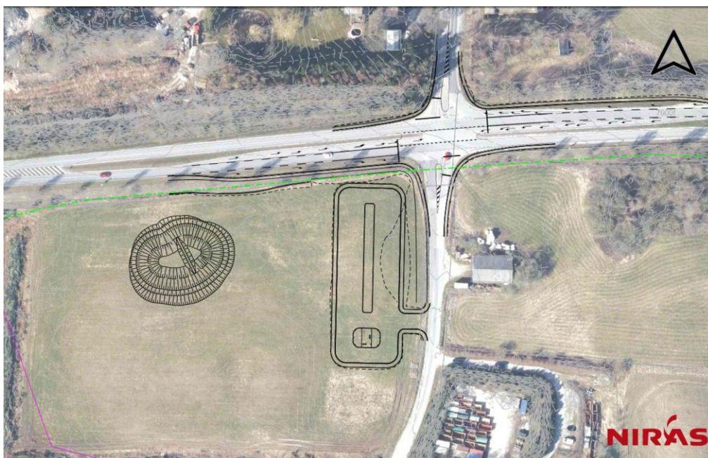
Figur 1 Krydsombygning og ny samkørselsplads ved Nordhøjvej/Herredsvejen. Vejvandsbassinet er inden for den røde cirkel
