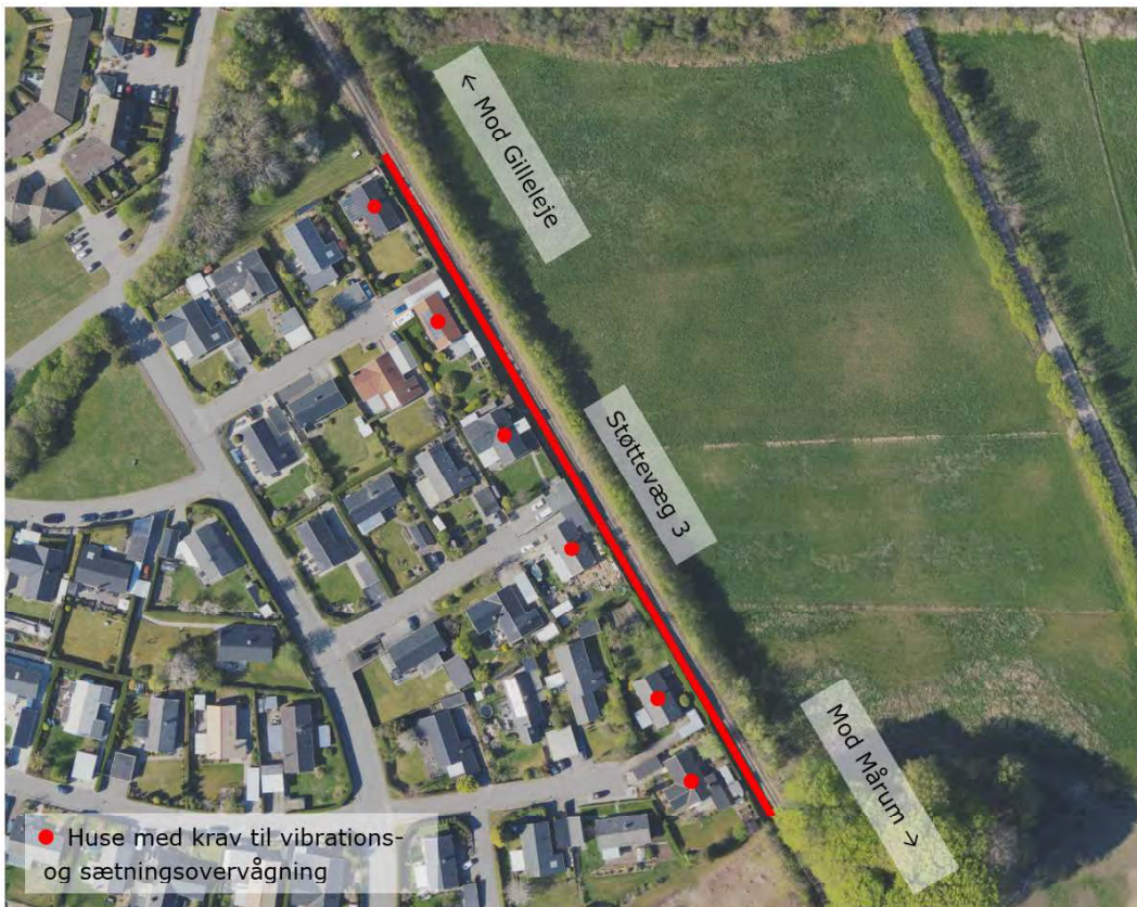
Figur 4-4 Placering af støttevæg 3 og markering af bygninger til vibrationsovervågning
