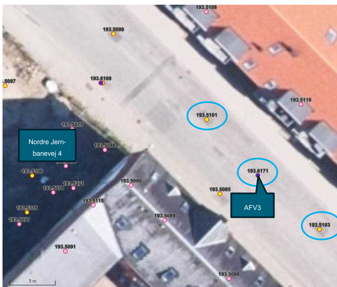
Figur 2 Prøvepumpning AFV3. Boringer med loggere i.
