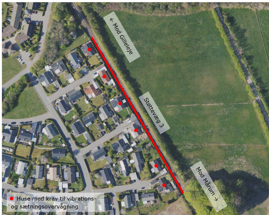
Figur 16-10 Placering af støttevæg 3 og markering af bygninger til vibrationsovervågning
