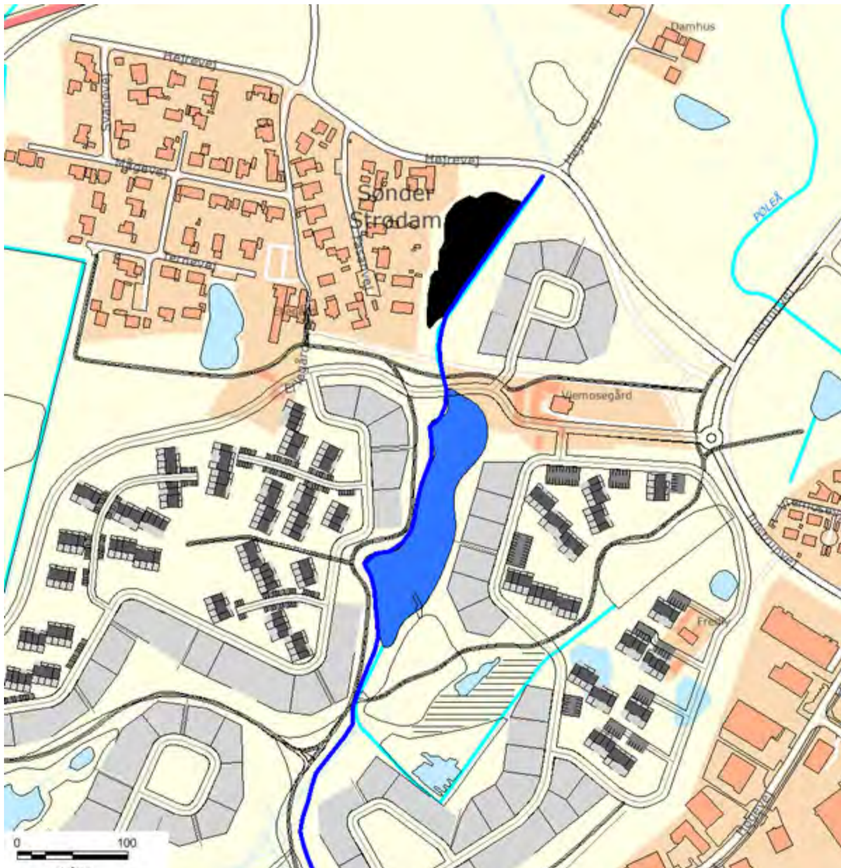
Figur 2. Plantegning af to forsinkelsesbassiner: vådbassin (blå) og tørbassin (sort)
