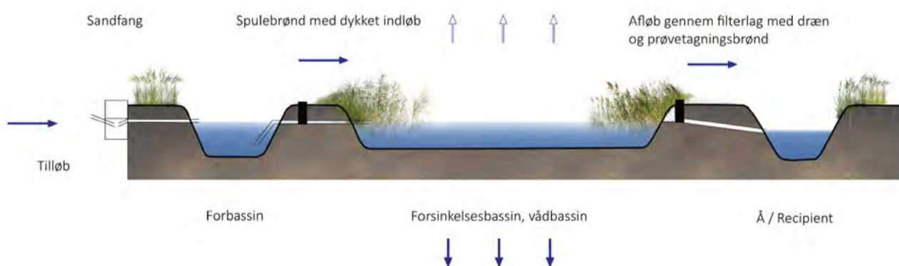
Figur 7. Principskitse af vådbassin. Ved skybrudssituation vil bassinets kapacitet være volumen mellem permanent vandspejl og øverste kant på bassinet.
